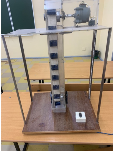
Рис 2. Фото станда для исследование работы нории.
