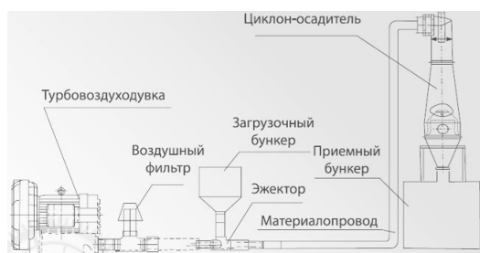
Рис.6. Схема пневмотранспорта.
