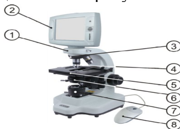
Рисунок – Общий вид микровизора: 1-штатив; 2-видеонасадка; 3-револьверное устройство; 4-объективы; 5-предметный столик; 6-конденсор; 7-осветительное устройство; 8-манипулятор «мышь».
